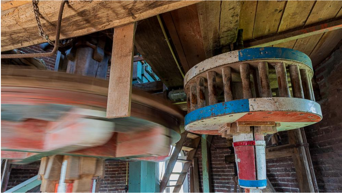
De steenzolder met spoorwiel en steenrondsel. Foto: Marko Barendregt.
